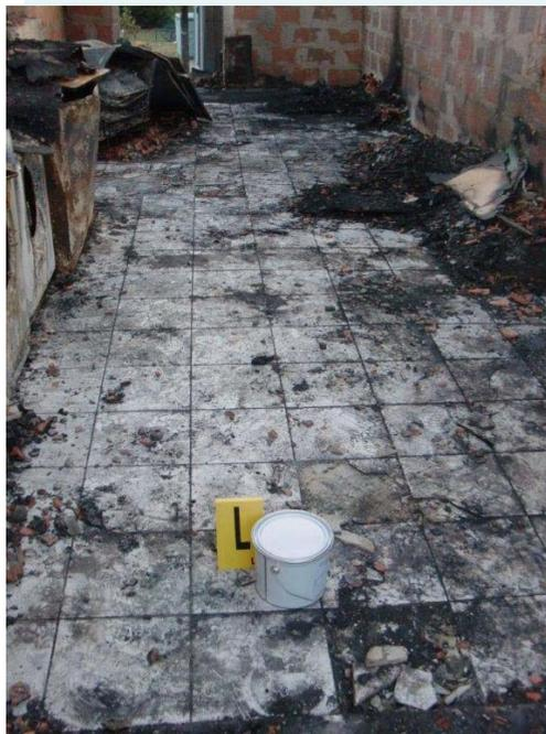
→ Absence d'accélération de combustion sur le scellé L
