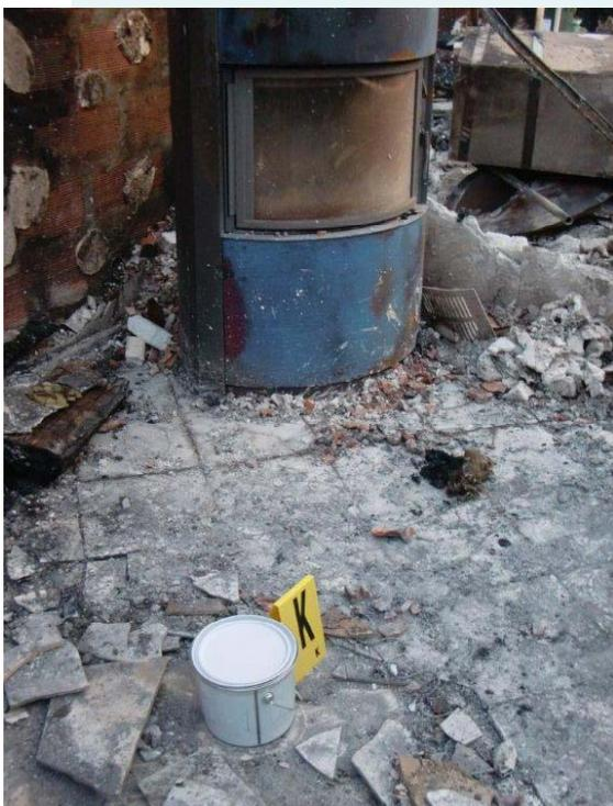
→ Présence probable d'essence automobile (profil altéré par combustion/évaporation)
